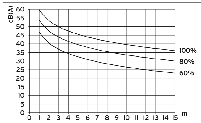
Obr. 6.3 Hladina akustického tlaku venkovní jednotky v dB(A) v závislosti od vzdálenosti a otáček ventilátoru pro instalaci VWL 101/3 S na volném prostranství
