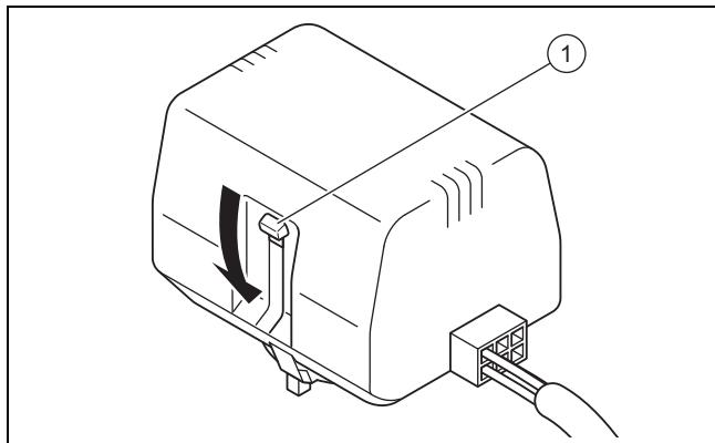
3. Pro nastavení přepínacího ventilu topení/nabíjení zásobníku do střední polohy stiskněte bílou přepínací páčku (1) na motorové hlavě přepínacího ventilu, až zapadne do střední polohy.
