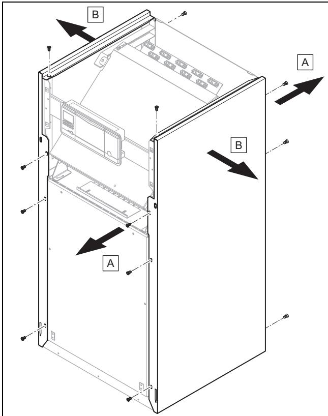
2. Při demontáži bočního dílu opláštění vyšroubujte 4 šrouby vpředu a 3 šrouby vzadu.
