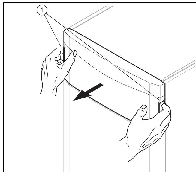
1. Přední sklopnou část ovládacího pole demontujte tak, že obě ruce vložíte do otvorů pro uchopení a přední sklopnou část odtáhnete dopředu.
