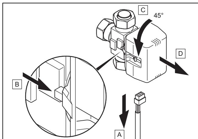
14. Odpojte napájecí kabel motorové hlavy přepínacího ventilu (A).
