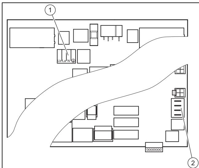
Pro připojení rozpojovacího relé externího studnového čerpadla je k dispozici přípojka přepínacího kontaktu X143 (1) s osazením Lb, La, N, PE.
