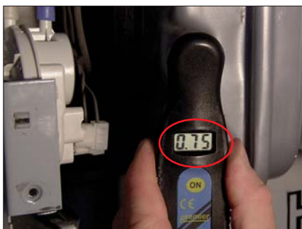
Obr. 4 Kontrola tlaku expanzní nádoby (požadovaná hodnota tlaku)
